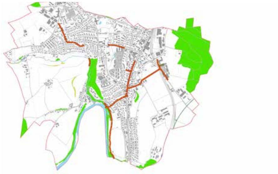
Abb. 37 Abwasserkanäle mit Durchmesser von mindestens einem Meter
