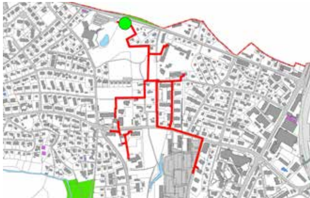
Abb. 35 Leitungsführung Wärmeverbund Nord mit Heizzentrale
