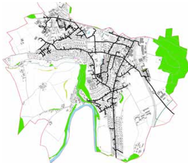
Abb. 34 Erdgasnetz Zollikofen (ewb)
