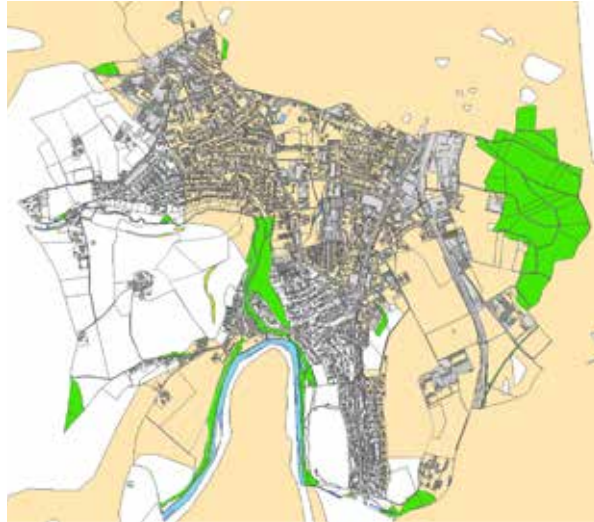
Abb. 39 Gebiete mit erlaubter Erdwärmesondennutzung (beige Farbe)
